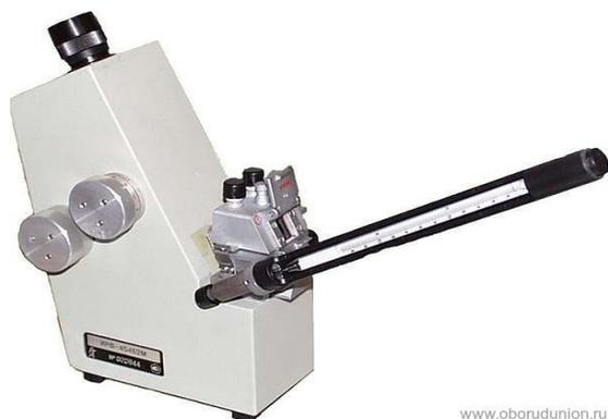
**Рис.2.** Рефрактометр ИРФ-454 Б2М
